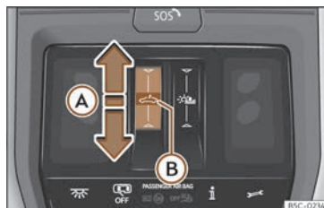
Fig. 90 Pe plafon: buton plafon din sticlă.
