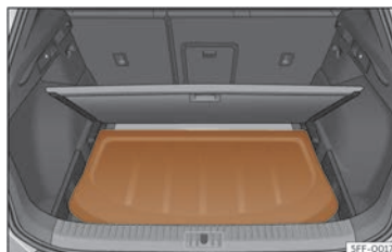
Fig. 188 În portbagaj: montarea copertinei portbagajului.
