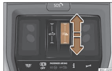
Fig. 92 Pe plafon: acționarea ruloului parasolar.
