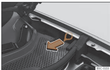
Fig. 66 Între panoul aripii stânga și balamaua capotei motorului: Declanșator pentru mecanismul de deblocare manuală al ștecărului de încărcare.
