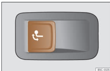
Fig. 199 Partea stângă a portbagajului: buton pentru deblocarea cârligului de remorcă.
