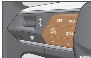
Fig. 137 Pe volanul multifuncțional: butoane pentru funcționarea tempomatului.
