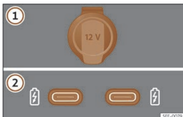
Fig. 175 Priza electrică de 12 V a autovehiculului.
