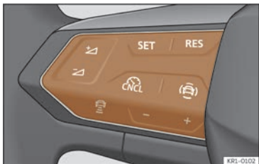
Fig. 119 Pe volanul multifuncțional: butoanele pentru controlul limitatorului de viteză.
