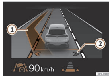
Fig. 132 Pe ecranul panoului de bord: afișaj asistent schimbare bandă (reprezentare schematică).
