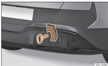
Fig. 190 Partea dreaptă a barei de protecție spate: inel de remorcăre înșurubat.
