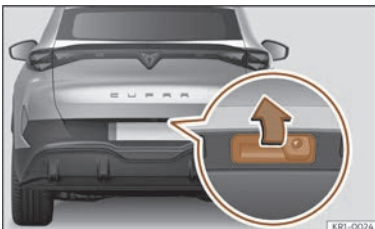
Fig. 77 Hayonul: deschiderea din exterior.
