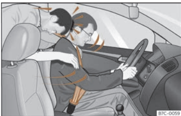
Fig. 19 Oricare dintre pasagerii de pe banchetă care nu poartă centura de siguranță pot fi proiectați violent în față, lovind șoferul care poartă centura de siguranță.
