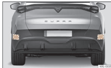
Fig. 115 Autovehiculul văzut din spate: suprafețele cu senzori radar.
