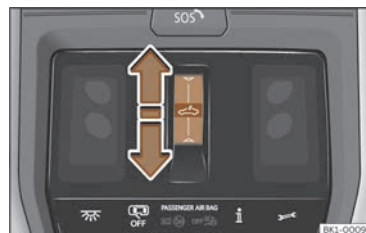
Fig. 101 Pe capitonajul interior al plafonului: suprafața de comandă funcții pentru acționarea parasolarului.
