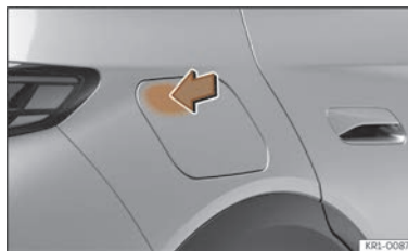
Fig. 55 Deschiderea capacului prizei de încărcare.
