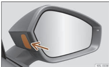
Fig. 134 Lampa de control asistent menținere bandă.
