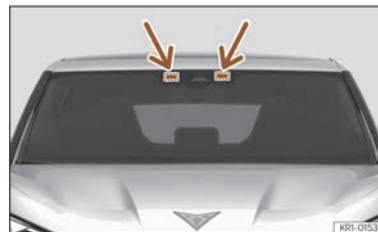
Fig. 107 Zona pentru amplasarea accesoriilor electronice
