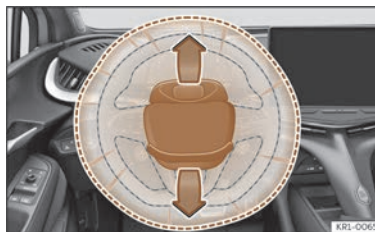
Fig. 25 Airbag pentru șofer în volan.
