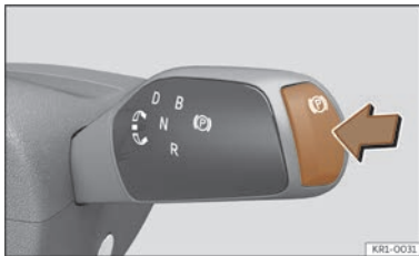
Fig. 137 Pe maneta selectorului: buton pentru frâna electronică de parcare.
