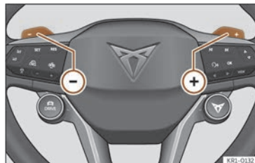
Fig. 110 Volan multifuncțional: padele de recuperare energie.
