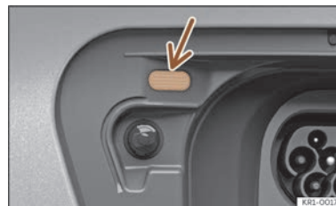
Fig. 59 În spatele capacului prizei de încărcare: indicatorul procesului de încărcare.
