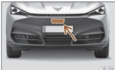
Fig. 112 Pe bara de protecție față: senzorul radar.
