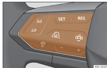
Fig. 118 Pe volanul multifuncțional: butoane pentru funcționarea tempomatului.
