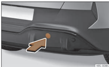
Fig. 189 Partea dreaptă a barei de protecție spate: demontați capacul.
