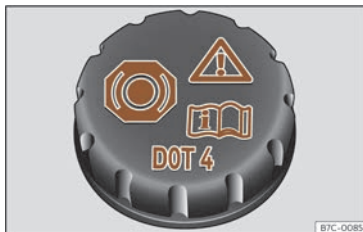
Fig. 199 Compartimentul motor: capacul rezervorului pentru lichidul de frână.
