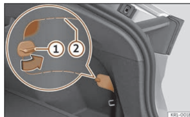
Fig. 61 În partea din dreapta jos a capitonajului portbagajului: capac cu marcaj pentru decupare.
