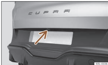
Fig. 117 Pe bara de protecție spate: amplasarea camerei pentru asistență la deplasarea marșarier.
