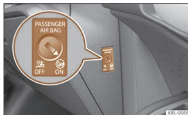
Fig. 27 Comutatorul pentru activarea și dezactivarea airbagului pasagerului față.
