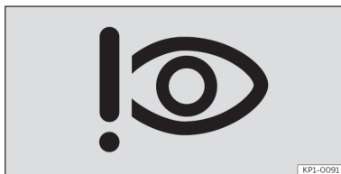
Fig. 6 Pe ecranul panoului de bord: Simbol sistem de avertizare atenție șofer.
