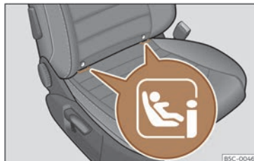
Fig. 38 Scaunul pasagerului față: amplasarea inelelor de asigurare i-Size.
