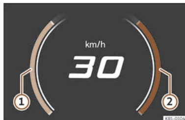
Fig. 3 Pe panoul digital al instrumentelor de bord: afișaj de putere (reprezentare schematică).
