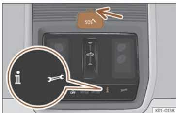
Fig. 47 Pe consola din plafon: comenzi pentru serviciile vocale.
