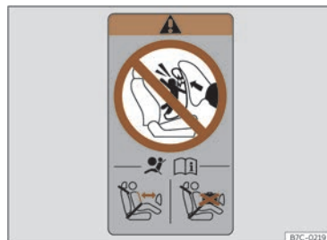
Fig. 36 Autocolant airbag: pe cadrul spate al ușii de pe partea pasagerului.
