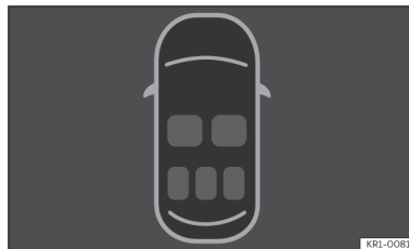
Fig. 17 Panoul de instrumente: afișarea stării de cuplare a centurii de siguranță.
