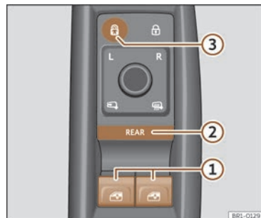
Fig. 81 Detaliu al ușii șoferului: comenzile geamurilor.
