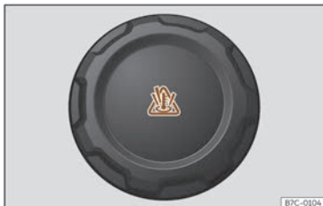
Fig. 198 Compartimentul motor: capacul vasului de expansiune pentru lichidul de răcire.
