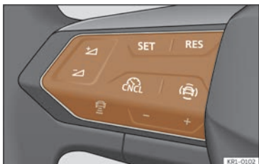
Fig. 122 Pe volanul multifuncțional: butoanele pentru operarea ACC.
