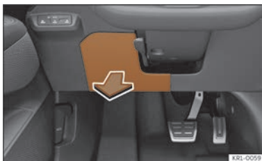
Fig. 191 Pe planșa de bord, pe partea șoferului: capacul cutiei de siguranțe.
