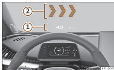
Fig. 4 În câmpul vizual al șoferului: HUD de proximitate ① și HUD RA ②.
