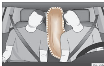
Fig. 30 Airbag central umflat complet (zona de declanșare).
