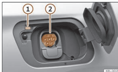
Fig. 56 În spatele capacului pentru încărcarea bateriei, în dreapta spate: Priză de încărcare
