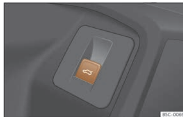
Fig. 78 De pe ușa șoferului: butonul de deschidere și închidere a hayonului.
