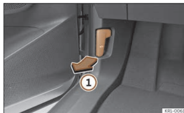
Fig. 195 Trageți de maneta din zona picioarelor șoferului.
