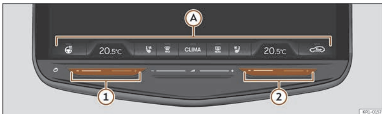
Fig. 102 Reprezentare schematică: funcțiile climatizării.
