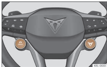
Fig. 111 Volanul multifuncțional: Butoane DRIVE și CUPRA pentru selectarea și modificarea profilului de deplasare.
