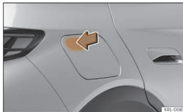
Fig. 57 Deschiderea capacului prizei de încărcare.
