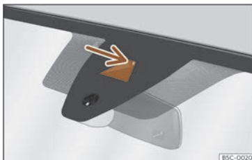
Fig. 114 Pe parbriz: câmpul vizual al camerei sistemului Lane Assist.
