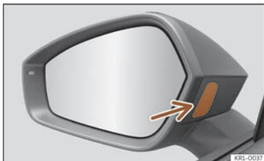
Fig. 133 Lampa de control asistent menținere bandă.
