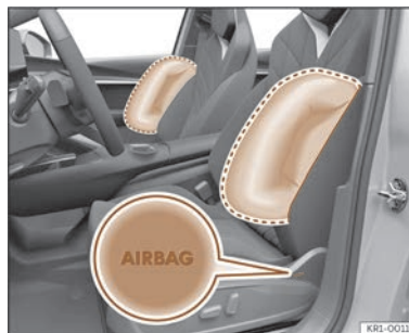
Fig. 31 Airbagurile laterale pentru scaunul șoferului și scaunul pasagerului.
