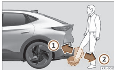
Fig. 80 Hayon cu deschidere controlată prin senzori (Easy Open).
