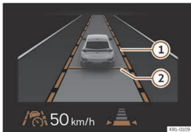
Fig. 129 Pe afișajul panoului de bord: afișarea reglării active (reprezentare schematică).
