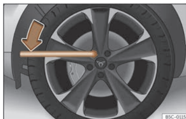
Fig. 206 Înlocuirea unei roți: slăbiți șuruburile de roată.
