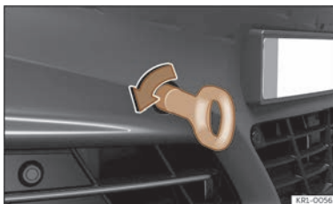
Fig. 188 Partea dreaptă a barei de protecție față: inel de remorcare înșurubat.
