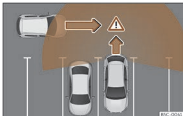
Fig. 146 Diagrama asistentului la parcare: zona detectată din jurul autovehiculului care iese din parcare.
