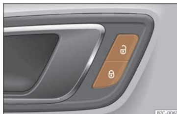
Fig. 48 Pe ușa șoferului: buton pentru închidere centralizată.
