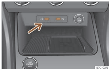
Fig. 153 Consola centrală: Intrarea USB.
