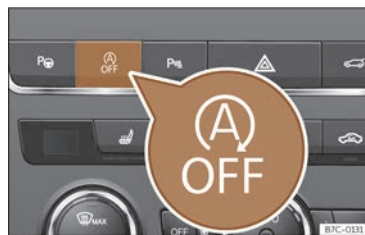
Fig. 90 Consola centrală: butonul sistemului Start-Stop.
