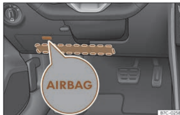
Fig. 29 Pe partea șoferului: amplasarea airbagului pentru genunchi.
