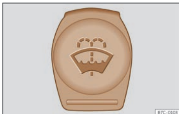
Fig. 202 În compartimentul față: capacul albastru al rezervorului instalației de spălare a geamurilor.
