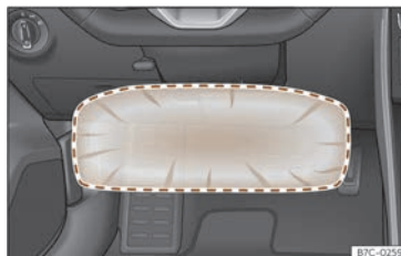
Fig. 30 Pe partea șoferului: raza de acțiune a airbagului pentru genunchi.
