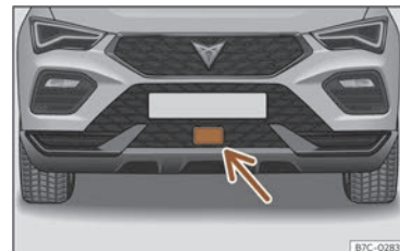
Fig. 100 Pe bara de protecție față: senzorul radar.
