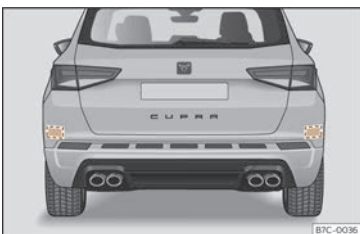
Fig. 103 Autovehiculul văzut din spate: suprafețele cu senzori radar.
