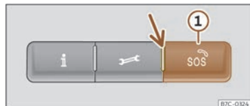
Fig. 40 Pe consola din plafon: comenzi pentru serviciile vocale
