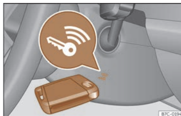
Fig. 89 Pe partea dreaptă a coloanei de direcție: pornirea de urgență.
