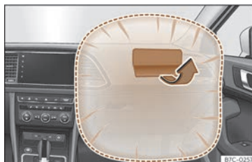
Fig. 23 Airbagul pentru pasagerul din față, situat în planșa de bord.
