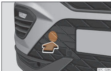
Fig. 189 Partea dreaptă a barei de protecție față: demontați capacul.
