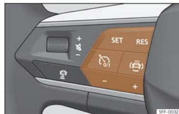
Fig. 106 Pe volanul multifuncțional: butoane pentru funcționarea tempomatului.
