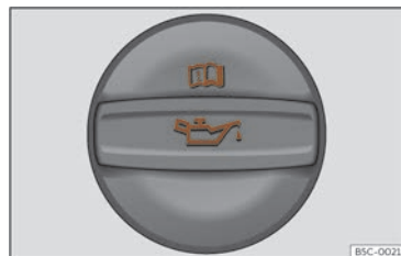
Fig. 206 Capacul bușonului orificiului de umplere cu ulei din compartimentul motor.
