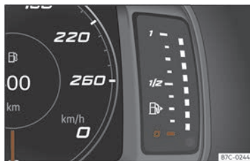
Fig. 2 Indicatorul nivelului de combustibil.
