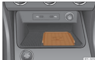
Fig. 160 Pe consola centrală: suport pentru conectarea telefonului mobil.
