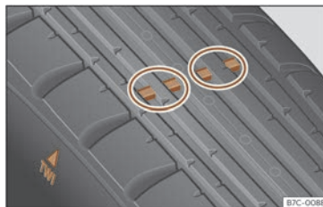
Fig. 209 Profilul anvelopelor: indicatorii de uzură a suprafeței de rulare.
