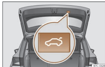
Fig. 54 Hayon: buton pentru închiderea hayonului.
