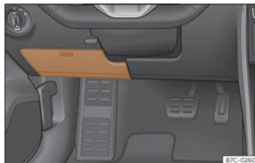
Fig. 193 Pe planșa de bord, pe partea șoferului: capacul cutiei de siguranțe.
