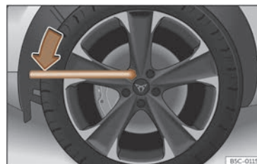
Fig. 215 Înlocuirea unei roți: slăbiți șuruburile de roată.
