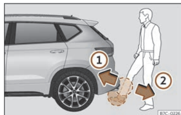
Fig. 56 Hayon cu deschidere controlată prin senzori (Easy Open).
