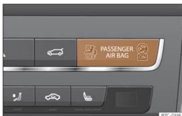
Fig. 25 Planșa de bord: lampa de control pentru airbagul frontal al pasagerului față dezactivat, de pe consola centrală.
