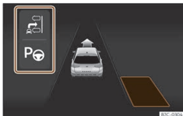
Fig. 134 Pe afișajul panoului de instrumente: afișarea sistemului de asistență la parcare cu vizibilitate scăzută.
