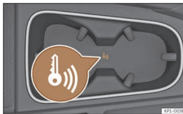
Fig. 115 Pe consola centrală: pornirea de urgență.
