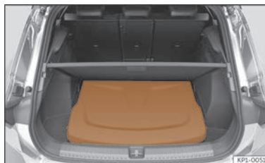
Fig. 184 În portbagaj: montarea copertinei portbagajului.
