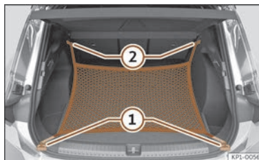
Fig. 191 În portbagaj: inele ① și cârlige ② pentru fixarea plasei pentru bagaje.
