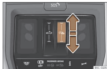
Fig. 89 Pe plafon: acționarea ruloului parasolar.
