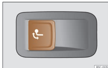
Fig. 196 Partea stângă a portbagajului: buton pentru deblocarea cârligului de remorcă.
