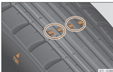
Fig. 235 Profilul anvelopelor: indicatorii de uzură a suprafeței de rulare.
