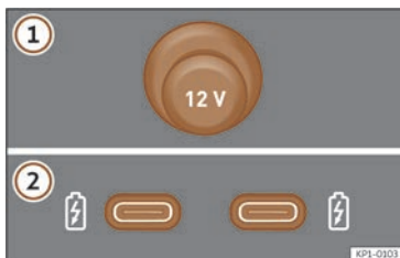
Fig. 170 Priza electrică de 12 V a autovehiculului.
