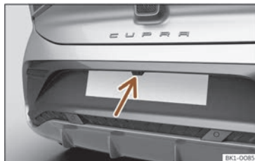
Fig. 114 Pe bara de protecție spate: amplasarea camerei pentru asistență la deplasarea marșarier.
