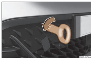
Fig. 178 Partea dreaptă a barei de protecție față: inel de remorcare înșurubat.
