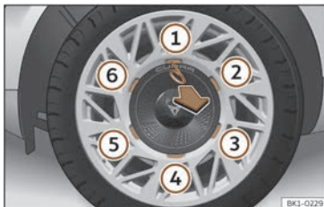
Fig. 192 Înlocuirea roții: demontarea ornamentului central.
