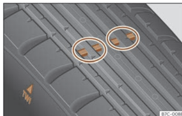
Fig. 190 Profilul anvelopelor: indicatorii de uzură a suprafeței de rulare.
