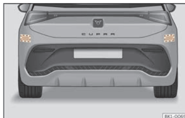
Fig. 112 Autovehiculul văzut din spate: suprafețele cu senzori radar.
