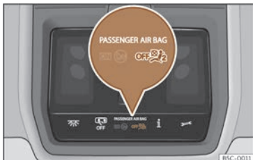
Fig. 27 Pe consola din plafon: lampă de control pentru dezactivarea airbagului pasagerului.
