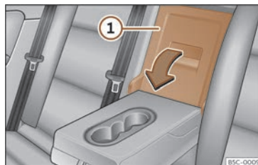
Fig. 168 Pe spătarul banchetei: deschiderea platformei.
