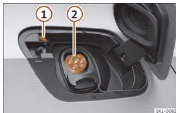
Fig. 56 În spatele capacului pentru încărcarea bateriei, în dreapta spate: Priză de încărcare
