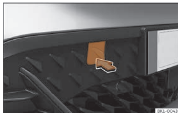
Fig. 177 Partea dreaptă a barei de protecție față: demontați capacul.
