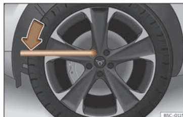
Fig. 195 Înlocuirea unei roți: slăbiți șuruburile de roată.
