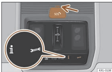
Fig. 46 Pe consola din plafon: comenzi pentru serviciile vocale.
