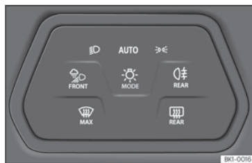
Fig. 93 Panoul de bord: panoul pentru lumini.
