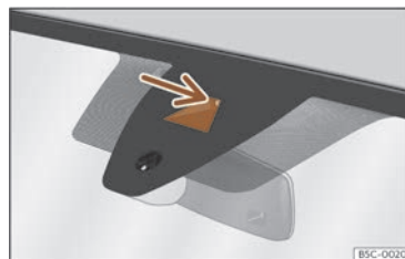
Fig. 111 Pe parbriz: câmpul vizual al camerei sistemului Lane Assist.
