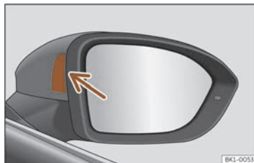
Fig. 130 Lampa de control asistent menținere bandă.
