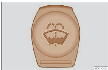
Fig. 188 În compartimentul față: capacul albastru al rezervorului instalației de spălare a geamurilor.
