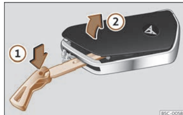
Fig. 69 Cheia cu telecomandă: deschideți capacul compartimentului bateriei.
