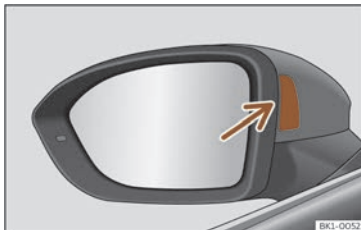
Fig. 129 Lampa de control asistent menținere bandă.
