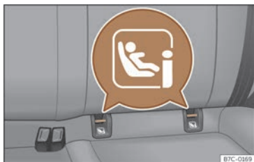
Fig. 36 Bancheta din spate: amplasarea inelelor de ancorare ISOFIX sau i-Size.
