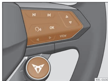
Fig. 82 Butoanele de pe volan.
