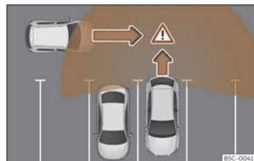
Fig. 165 Diagrama asistentului la parcare: zona detectată din jurul autovehiculului care iese din parcare.
