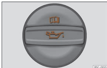
Fig. 237 Capacul bușonului orificiului de umplere cu ulei din compartimentul motor.
