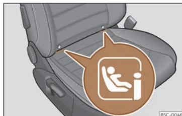
Fig. 41 Scaunul pasagerului față: amplasarea inelelor de asigurare i-Size.
