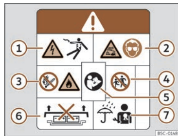
Fig. 56 Inscripționări de avertizare baterie de înaltă tensiune.
