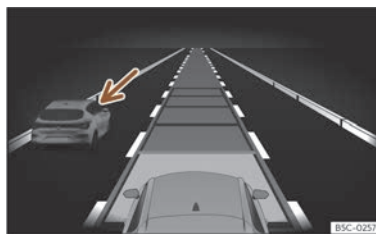
Fig. 141 Pe ecranul panoului de bord: ACC activ, autovehicul detectat în stânga.
