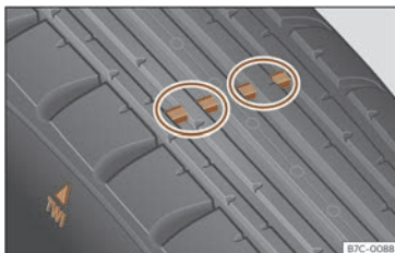
Fig. 242 Profilul anvelopelor: indicatorii de uzură a suprafeței de rulare.
