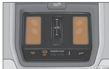
Fig. 109 Detaliu plafon: luminile interioare din față.
