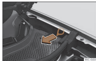
Fig. 65 Între panoul aripii stânga și balamaua capotei motorului: Declanșator pentru mecanismul de deblocare manuală al ștecărului de încărcare.
