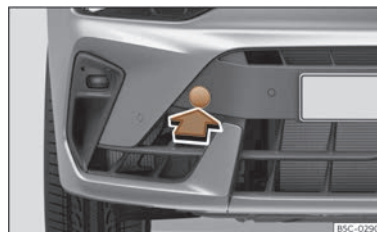
Fig. 219 Partea dreaptă a barei de protecție față: demontați capacul.
