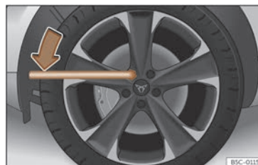
Fig. 248 Înlocuirea unei roți: slăbiți șuruburile de roată.
