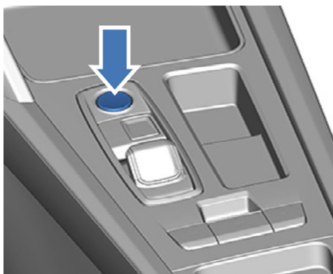
Autovehicul cu buton START-ENGINE-STOP în consola centrală.
