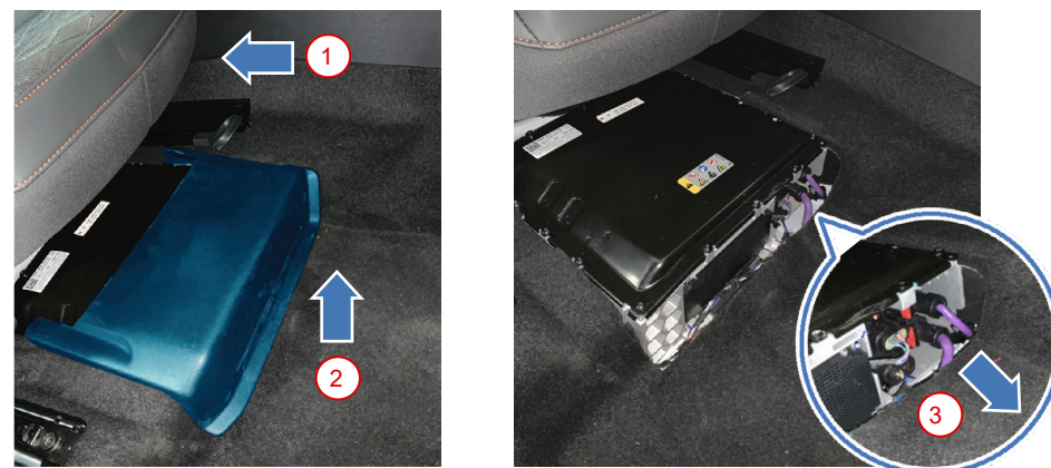
Deconectarea instalației electrice de 48 V a autovehiculului în autovehicule mild hybrid (MHEV).
