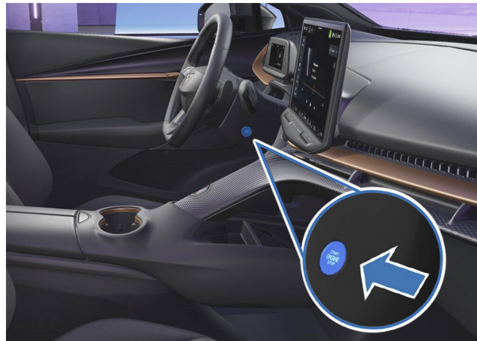
Autovehicul cu buton START-ENGINE-STOP pe coloana de direcție.
